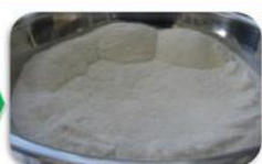
②乾いた米を製粉機に入れ、6度挽き作業をする。
